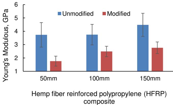
**Figure** Tõrge! Dokumendis pole määratud laadis teksti.. Young’s modulus of unmodified & modified HFRP composites with varying fibre lengths (Alao, 2018).
